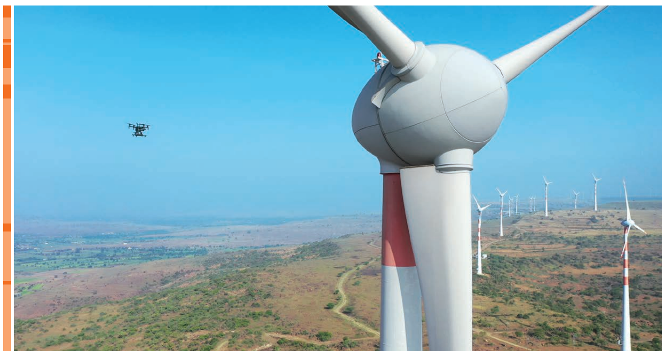
印度業務試驗以配備高解像度相機的無人機，檢查風力發電機葉片。
