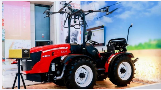
公司自主研发中国首台丘陵山地拖拉机东方红MH804M
