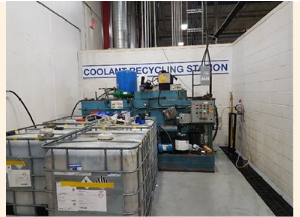
在加拿大的安卡斯特，檢測了其現場冷卻液回收計劃，並確定可以回收更多冷卻液，每年可節省 38,000 升冷卻液濃縮液及 450,000 升水
