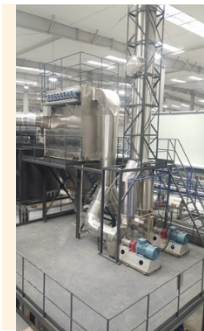
磁鐵生產中迴轉窯產生的排出空氣呈酸性
