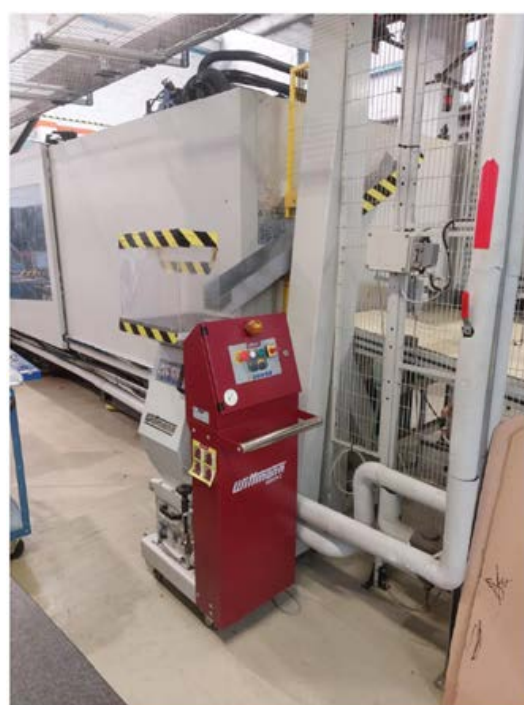
在意大利阿斯蒂（Asti）的生產線上添置研磨機，以回收塑料澆口以在生產中重複使用。這些機器於 2021 年 9 月安裝，直至 2022 年 3 月底，已經回收了 20 噸物料
