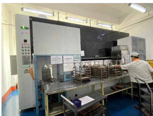
集團購買多台碳氫化合物清洗機，並禁止使用之前在中國沙井和江門廠房進行清洗用的消耗臭氧層的氯氟碳溶劑
