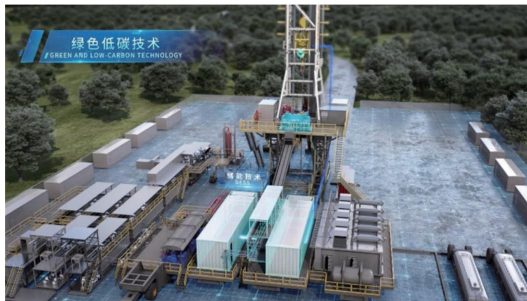
2023年8月28日，宏華集團發佈首臺全國產化智能鑽機——HH Smart Rig1.0智能鑽機。HH Smart Rig1.0智能鑽機運用的儲能及能量管理系統，能夠智能識別鑽井工況並採用內置策略演算法自動啟停發電機，有效提升發電機運行效率，減少發電機運行時間，實現鑽井作業的綠色、環保。
