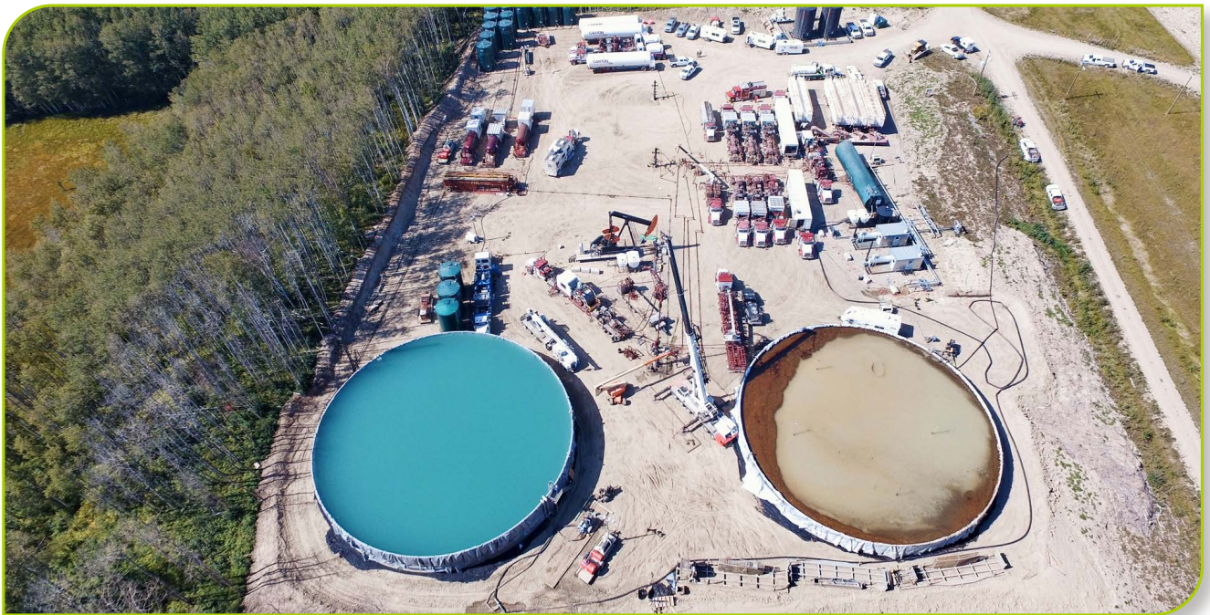
Recycling wastewater from hydraulic fracturing 對水力壓裂產生的廢水進行回收處理
