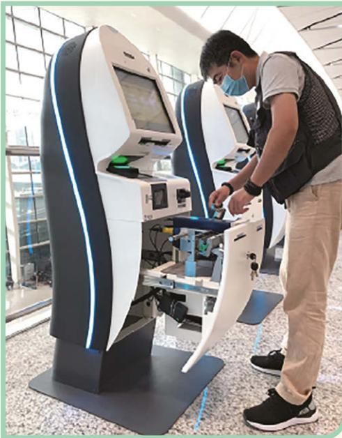
● 航信員工正在調試自助值機設備
