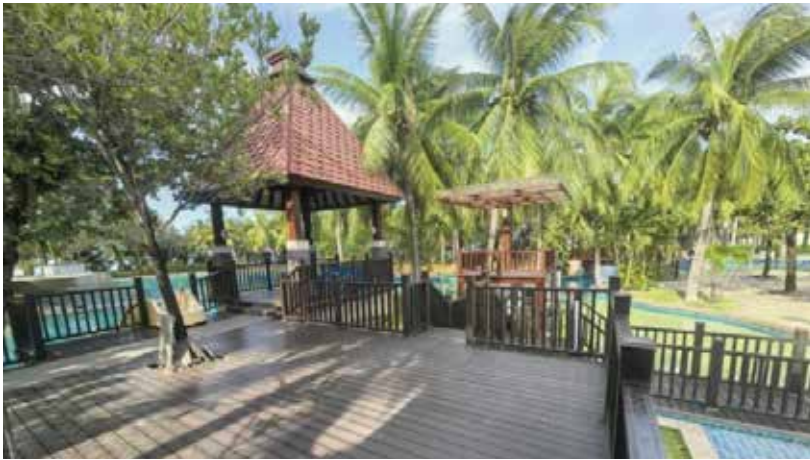
退役風機葉片回收再利用製成型材，用於酒店戶外地板鋪設
