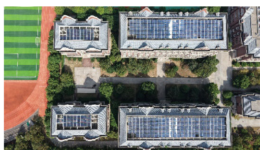
圖4-3 境內校區宿舍太陽能熱水系統
