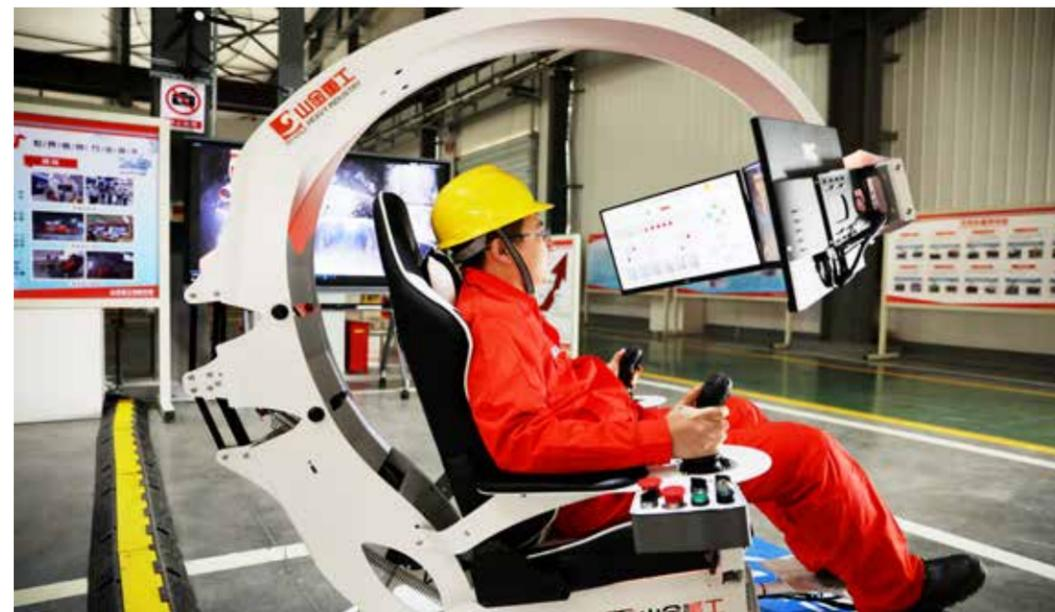
全國首例礦山大型無軌設備基於WiFi6 Mesh組網的遠程操控在焦家金礦-寺莊分礦試驗成功，實現地表遠程操控無軌設備
