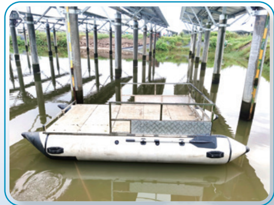
水上光伏作業船
