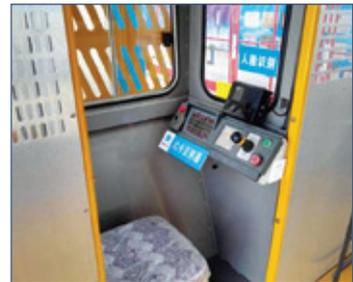
施工電梯司機人臉識別系統
