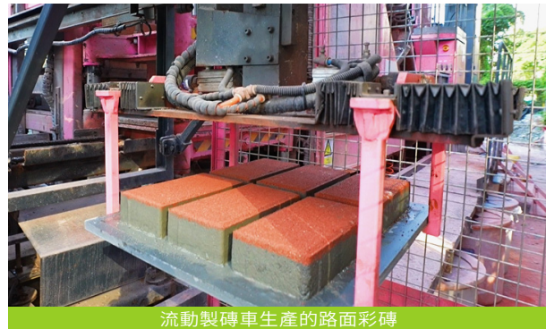
流動製磚車生產的路面彩磚
