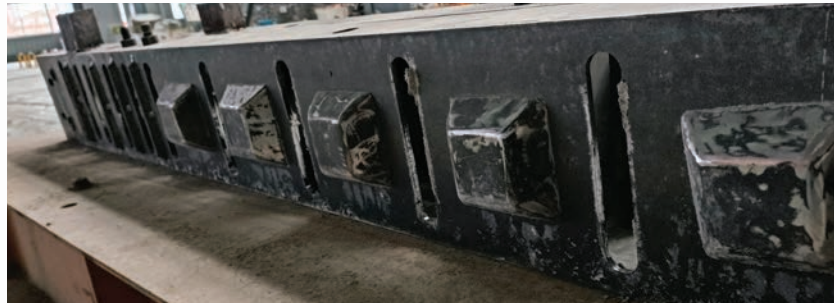
圖2：剪力鍵替代粗糙面工藝
