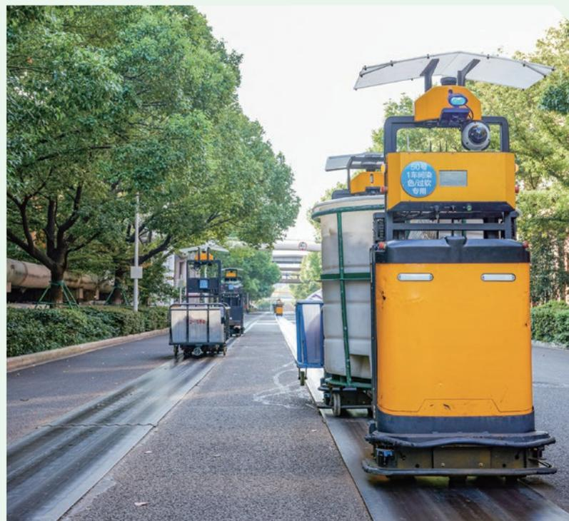
圖11：AGV自動引導車在寧波生產基地運行，由綠色電力提供動力
