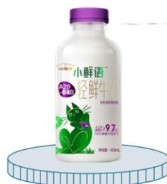
蒙牛旗下每日鮮語小鮮語品牌 450ml 產品通過瓶型創新結構設計，將原有 PET 瓶重量從 36g 降至 32g，降低包裝成本同時也提升瓶型抗負壓性能，並且增加設計趣味性，與市場上同類產品形成明顯差異化。
