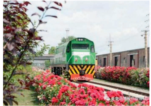
國內首台由舊內燃機車改造而成的 純電動調車機車
