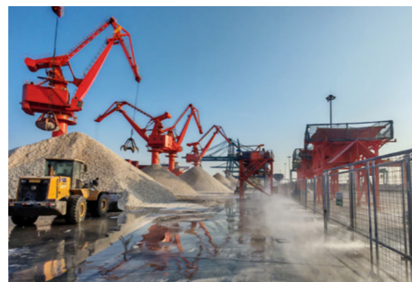
秦港股份杂货公司自主研发的港区场道智能喷淋湿润抑尘系统
