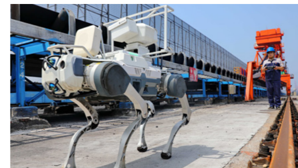
秦港股份九公司工作人员在堆场内对四足巡检机器人进行作业前例行检查
