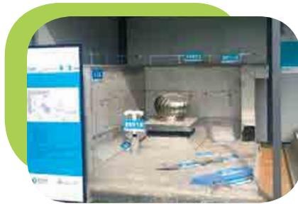
屋面工法：多達7層屋頂防水工序，並採用聚氨酯防水塗料、擠塑聚苯板等多種材質，確保屋面不發生滲漏，並方便檢修。
