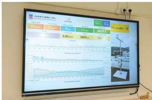
我們與多間小學合作，推出了「5G天氣儀」培訓課程，旨在提高學生對氣候變化的意識。學生可透過「5G天氣儀」了解天氣變化，該儀器將從IoT智能設備收集的數據傳送至雲端平台系統進行分析和大數據處理，同時透過5G天氣站發出即時通知。該課程還提供關於智能設備、數據收集、自動化和編程的培訓，以及極端天氣條件和可持續發展的重要性。
