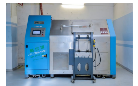
餐厨垃圾处理设备
