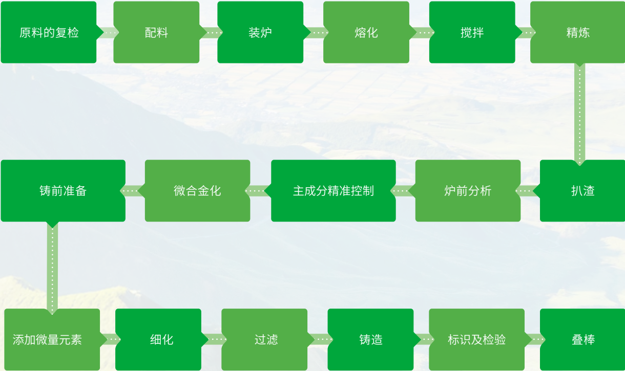
▲ 再生铝熔铸工艺流程
