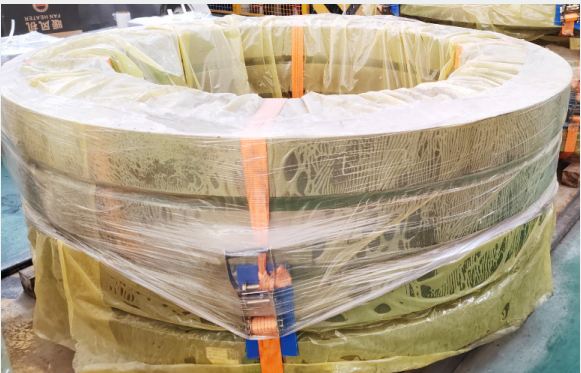
改良后，使用托盘、防锈膜、打包带包装
