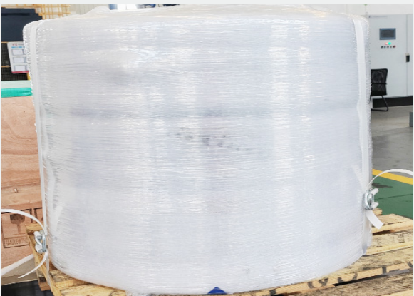
改良后，使用托盘、防撞棉、打包带包装
