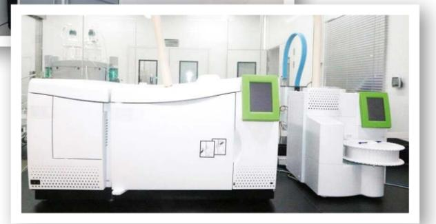
全自动热脱附 - 气相色谱 / 质谱 (ATD-GC / MS) 联用仪
